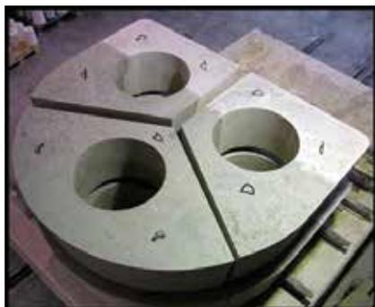
Центральная часть свода электродуговой сталеплавильной печи
